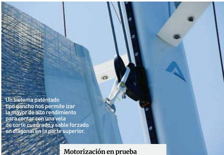
Un sistema patentado tipo gancho nos permite izar la mayor de alto rendimiento para contar con una vela de corte cuadrado y sable forzado en diagonal en la parte superior.
