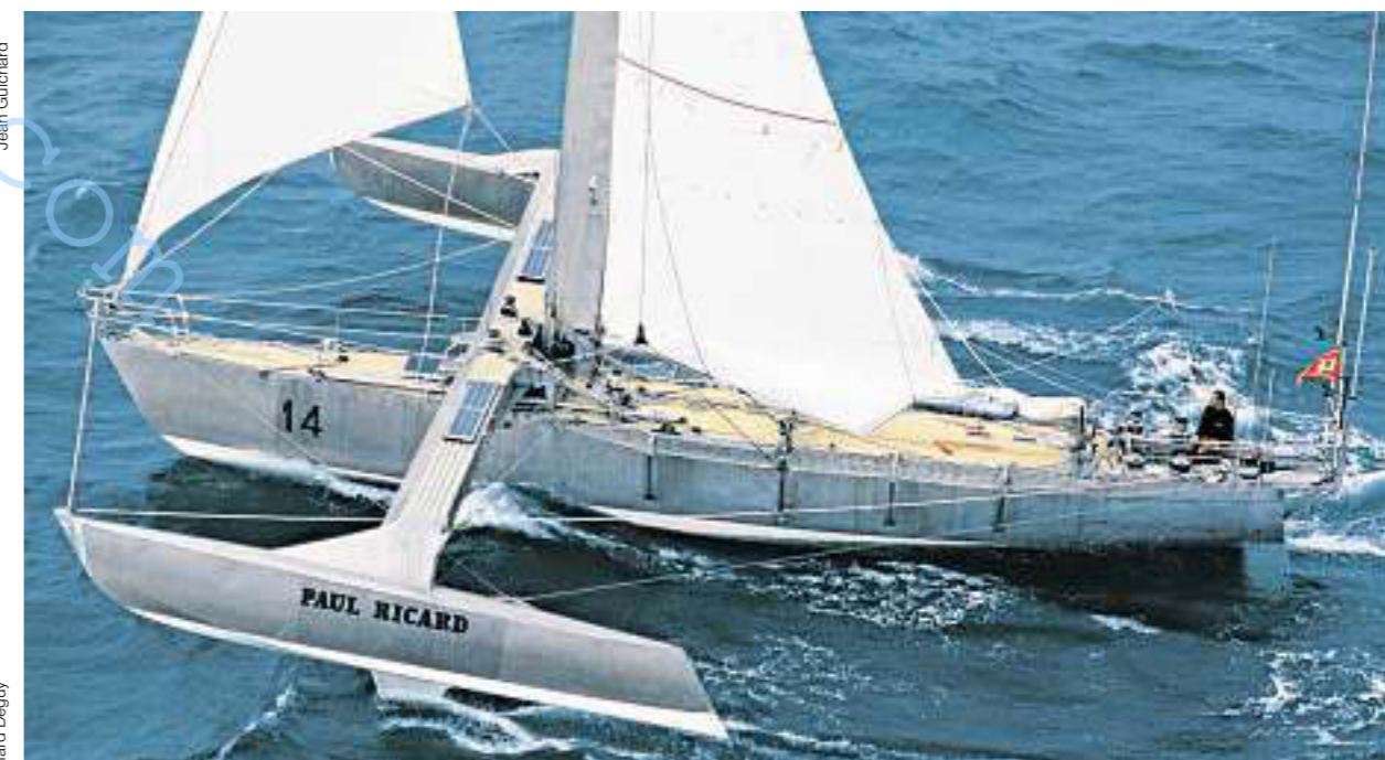
En inventant le mât en forme d'aile profilée, forme aujourd'hui popularisée, Éric Tabarly est en avance sur son temps.
