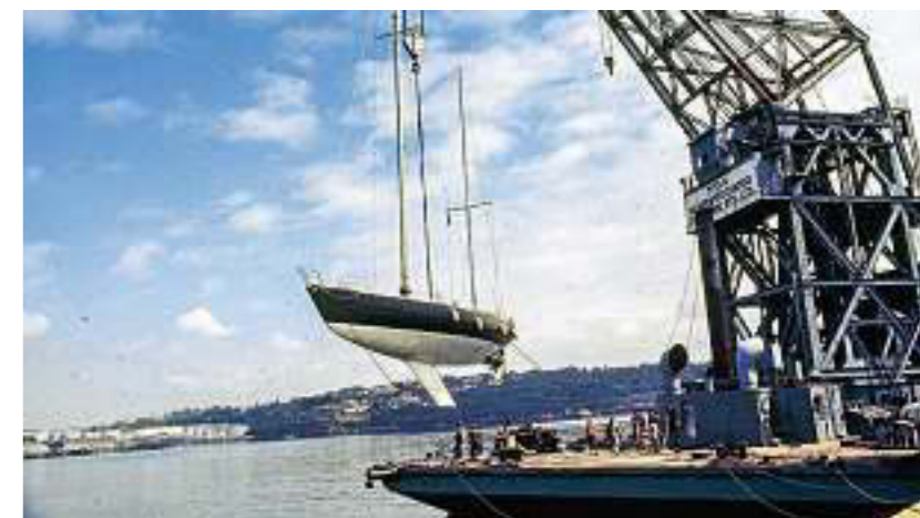
Le Pen Duick VI fut équipé à ses débuts d'une quille en uranium.
