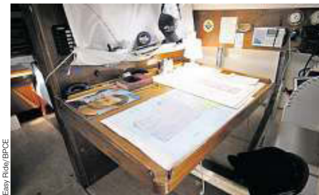
La selle d'Harley était un clin d'œil; l'important est l'installation de la table à cartes de Pen Duick II sur cardan.
