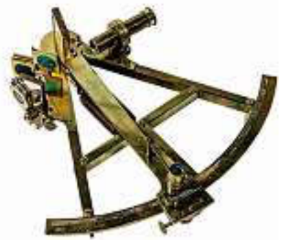
Le sextant, instrument de mesure d'astres inventé au XVIII e siècle, est toujours obligatoire en mer.
