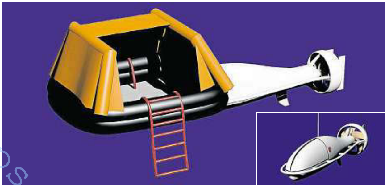
Le drone de sauvetage se déplace automatiquement jusqu'au naufragé, à une vitesse d'environ 5 nœuds.
